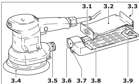
Les machines sont équipées en série d'un dispositif d'auto-aspiration. La poussière de ponçage est aspirée à travers les orifices d'aspiration du patin de ponçage (3.4) puis collectée dans le filtre turbo (3.2).
